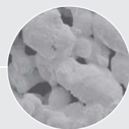
キューブ表面の拡大画像(300倍) 隙間を残しながら顆粒同士をしっ かり接着させて強度を増している。
