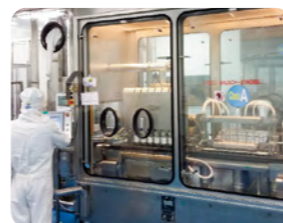
スルバシリンのバイアル充填工程(PT、メイジ・インドネシア・ファーマシューティカル・インダストリーズ Bangil工場)
