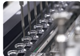
5,700万人分のワクチン製剤化工程を担う合志事業所の充填設備
