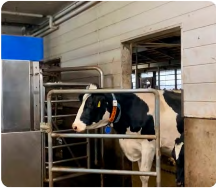
搾乳ロボットに入る牛。 首につけたタグの情報を機械が読み取り、個体情報を識別。
