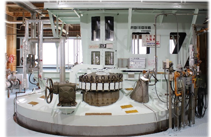
165kL発酵槽 (ペニシリン原料培養用)
